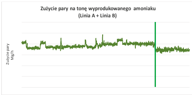
Wykres zużycia pary oraz emisji CO 2 dla pieca reformingowego, zoptymalizowanego przy użyciu narzędzi Honeywell AES w jednym z zakładów w Polsce
